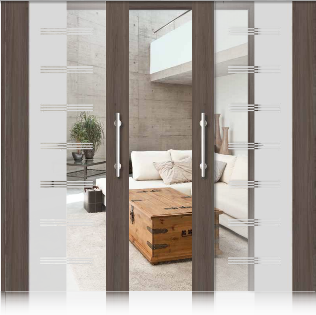
1 MODELL: I-1/LA, 2-FLG., SCHIEBETÜRBESCHLAG SLIM, AUSFÜHRUNG MIT ZARGE, CPL PERA DARK (bei INTARSIA nur ohne Softstop möglich) GLAS: LINEUM, Siebdruck-Veredelung MODEL: I-1/LA, DOUBLE WINGED, SLIM SLIDING DOOR MOUNTING, EXECUTION WITH FRAME, CPL PERA DARK (in INTARSIA range only possible without softstop) GLASS: LINEUM, Screenprint finish
