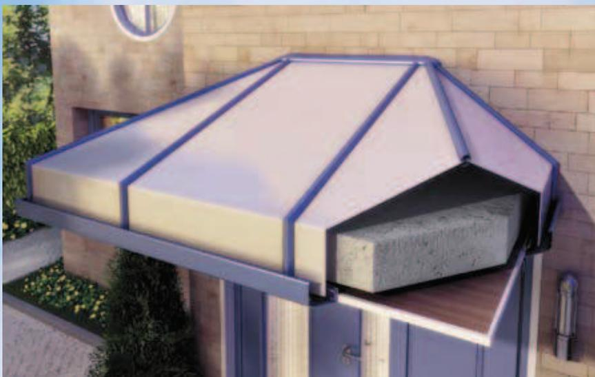
Das Prinzip der Abdeckung alter Betonvordächer
